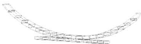
图 2 ADAMS 中钢板弹簧多体动力学模型
