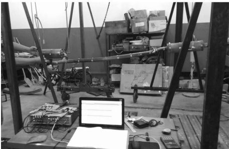
图 4 排气管的自由模态试验安装与测试
