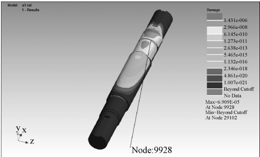
图 11 车轮轴疲劳损伤云图
