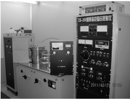
图1 CS-300 磁控溅射镀膜机
