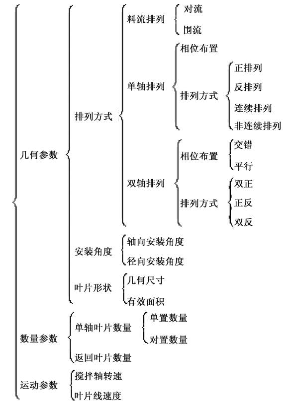
图 1 搅拌叶片参数 Fig.1 Parameters of mixing blades
