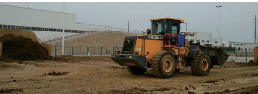
图 3 散状物料铲装试验图 Fig.3 Bulk material loading test
