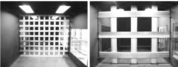
图1 格栅风场 Fig.1 Turbulence field of grilles
