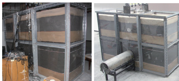
(a) 模型箱 (b) 盾构装置
