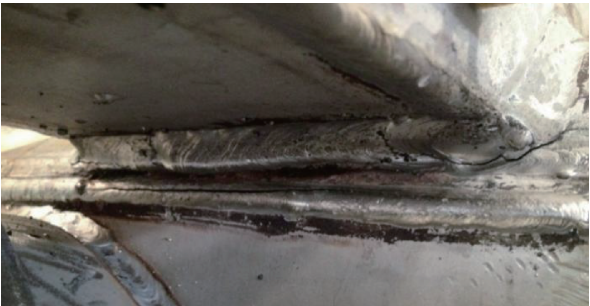
图 7 焊缝失效结果图
