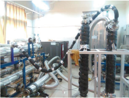
图 12 换热器性能实验测试平台
