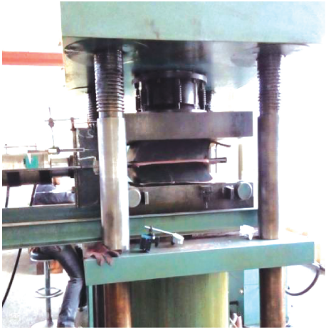
图 2 平面剪切试验过程图 Fig.2 Process diagram of plane shear test
