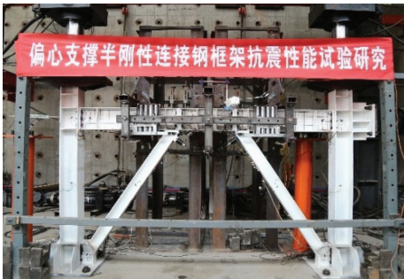
图 1 试验加载装置 Figure 1 Test loading device
