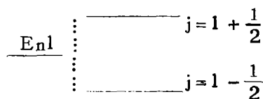
图1, 碱金属原子能级的精细结构图
