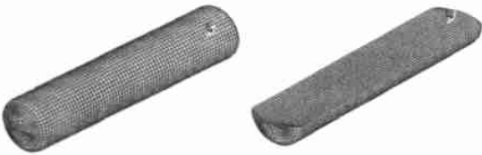
(a) 结构有限元网格 (b) 流体有限元网格 图 1 卧式油罐的有限单元网格和流体单元网格 Fig.1 The FEA mesh of cylindrical container and fluid
