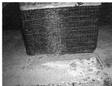
(c) 左柱根破坏图
