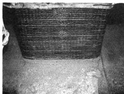
(d) 右柱根破坏图
