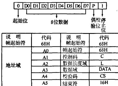
图 4 电表通信字节格式和帧格式
