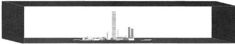
图2 超高层塔楼的数值风洞及模型
