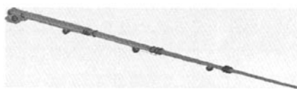
图 3 臂架有限元模型
