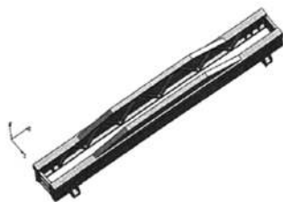
图 8 优化后横梁结构
