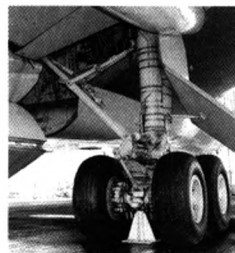
图1 起落架收放平面机构
