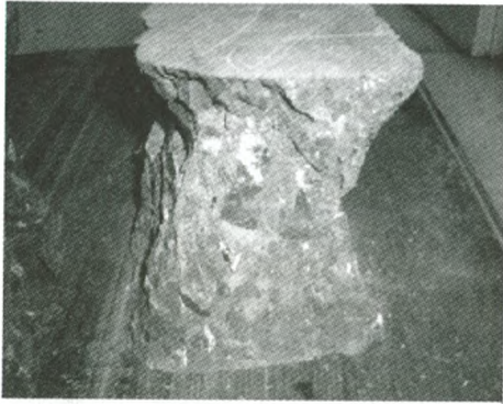
图2 再生混凝土立方体抗压破坏形态
