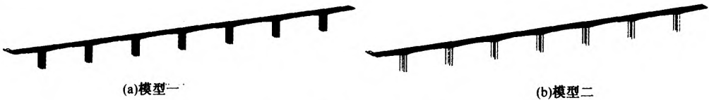
图 2 全桥有限元模型 Fig.2 Finite element model of the full bridge
