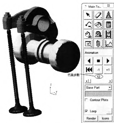
图 7 t=0.012 s 时凸轮摇臂所处位置图
