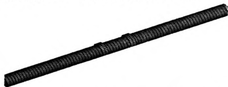
图 3 混合配筋管桩和垫块的单元网格模型 Fig. 3 The grid model of PRC Pipe Piles and pad
