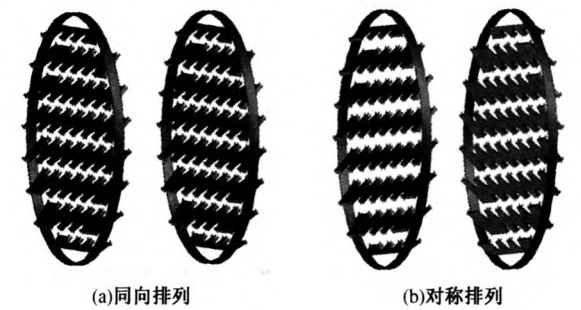
图 1 不同的折流栅排列方式 Fig. 1 Different assemblies of shutter baffles
