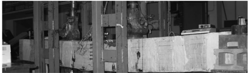
图 3 试验梁破坏特征
