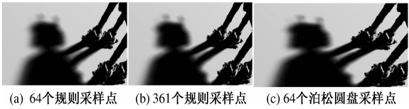
图 7 不同采样模式对软阴影效果的影响 Fig. 7 Effect of the different sampling patterns
