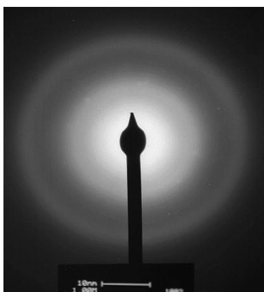
图 5 铁钴样品的电子衍射
