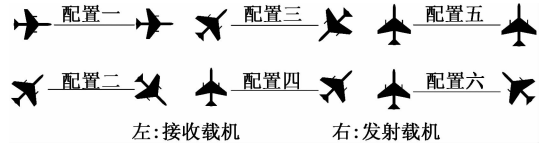
图 2 机载双基雷达典型几何配置结构图 Fig. 2 Typical cases of airborne bistatic radar geometry
