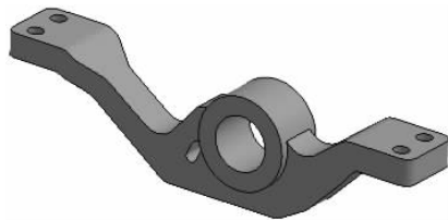
图5 油缸支架设计方案
