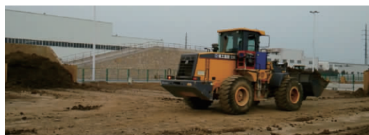
图3 散状物料铲装试验图
