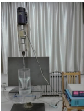
图1 水模试验装置
