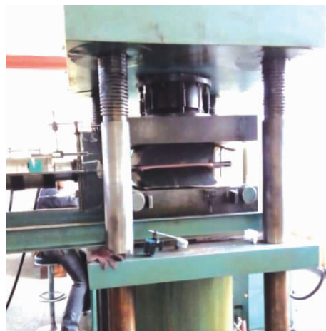
图 2 平面剪切试验过程图
