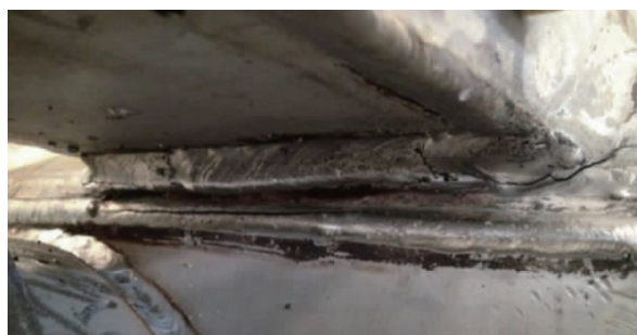
图7 焊缝失效结果图
