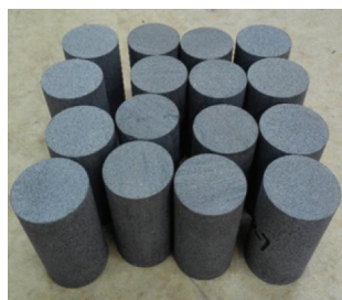
图1 部分加工好的试件
