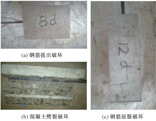
图 3 试件破坏模式
