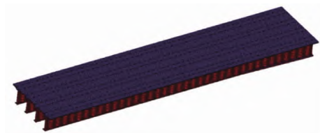
图4 波形钢腹板组合T梁桥有限元模型(单跨)
