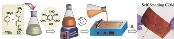
图 6 通过原位烘烤方法制备 COF 膜的示意图 [45]
