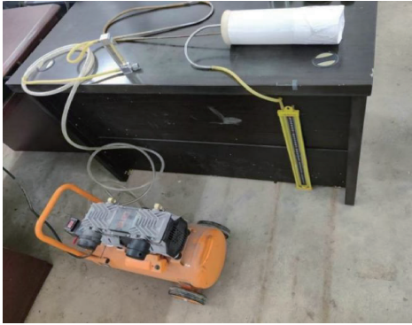
图 3 流阻率测量装置
